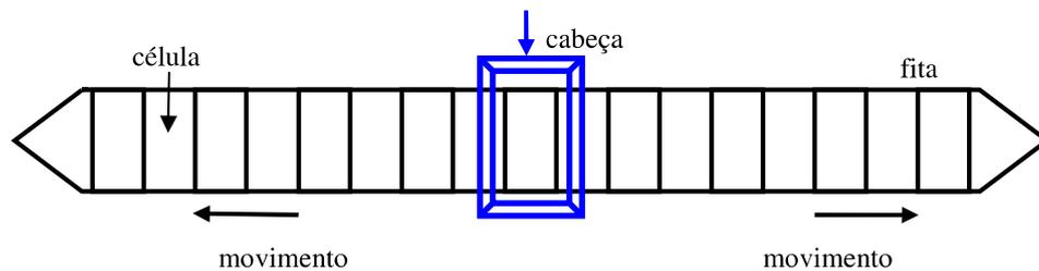
Figura 1. Diagrama da Máquina de Turing
