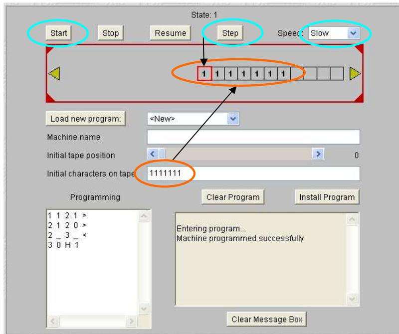
Figura 9. Simulador da Máquina de Turing com o Programa Instalado
