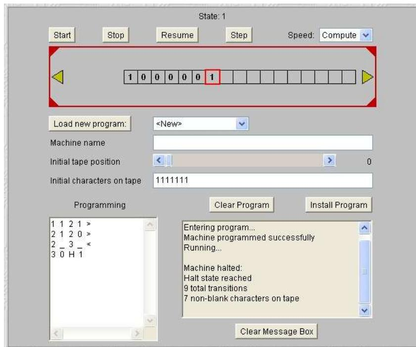
Figura 10. Simulador da Máquina de Turing com o Programa Executado
